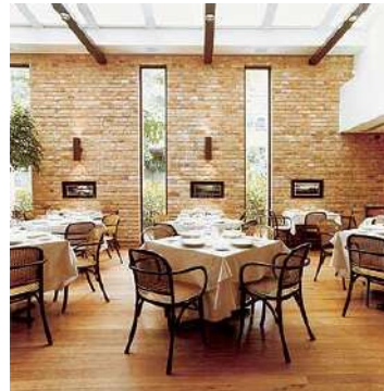
Seteiras e abertura zenital trazem luz natural para o interior. A abertura zenital é protegida por tela térmica.
