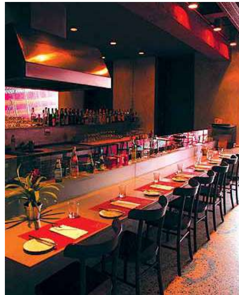
A redução da altura do balcão integrou visualmente o espaço e permitiu a instalação da bancada metálica
